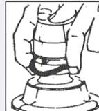
Ziehen Sie den O-Ring des Federrings hoch in die Nut des Kraftsteckschlüssels.
