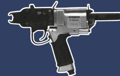
Die Ringklammergeräte von Yokota sind für die Fertigung von Autositzen und Matratzen bestens geeignet. Dieses Werkzeug kann Bezüge und Leder am Sitzrahmen mit Ringklammern befestigen.
