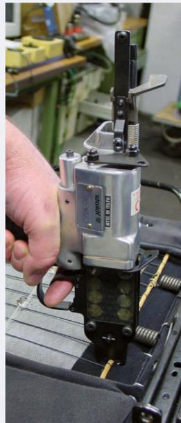
Hebel anziehen und klammern. Der Vorgang ist beendet, wenn Sie den Hebel wieder loslassen.
